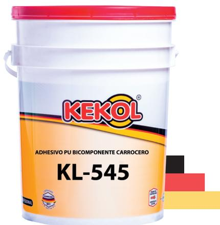
Sistema adhesivo bicomponente libre de plastificantes, ideal para la unión de metales, madera y espumas rígidas. Se mezcla en proporción 5:1 formando un adhesivo elástico, sin modificación volumétrica. Aplicar con mezcladora o sistema dosificador sin aire. Mantener presión durante el curado.
