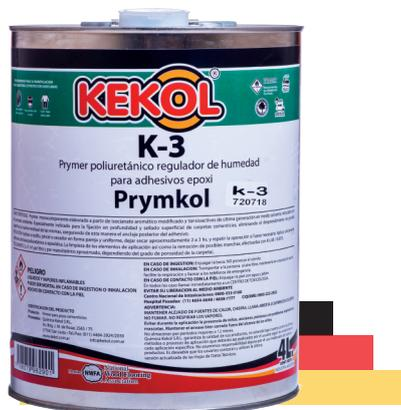
Sellador monocomponente base solvente, formulado para consolidar carpetas cementicias antes de aplicar adhesivos epoxi. Penetra en profundidad, fija el polvo suelto y evita el desprendimiento de la granalla superficial. Mejora el anclaje del adhesivo final. Ideal para la preparación de carpeta en ambientes interiores con riesgo de polvo o mala cohesión superficial.
