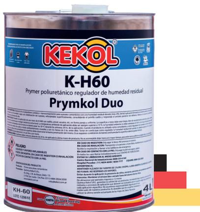
Imprimación de alta penetración formulada para regular la humedad residual de carpetas cementicias y consolidar superficies débiles. Compatible con sistemas epoxi, vinílicos y uretánico. Especialmente formulado para la preparación de carpetas con hasta 6% de humedad residual. Reforzamiento superficial previo a adhesivos de cualquier tipo. Aplicaciones sobre pisos radiantes (máx. 30 °C en primeras 24 hs).
